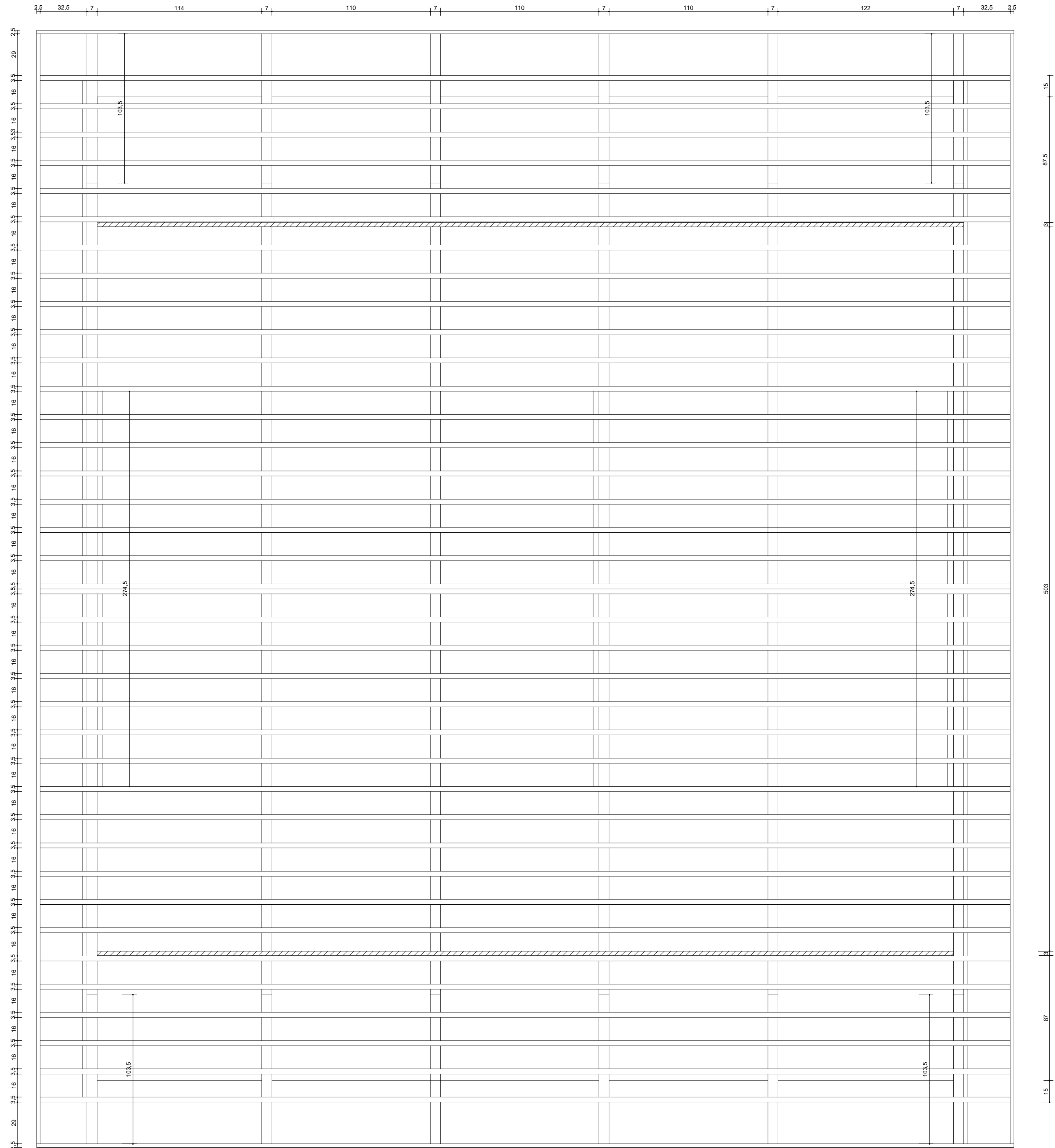
PLANTA DA ESTRUTURA DA COBERTURA - CAIBROS E RIPAS ESCALA 1:50
